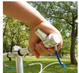
パームブレーキバーを装着した自転車(ブレーキをかけていない状態)
